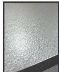
屋根や外壁に使われているガルバリウム鋼板を使用し防錆性、傷に強く定評のある素材です。
